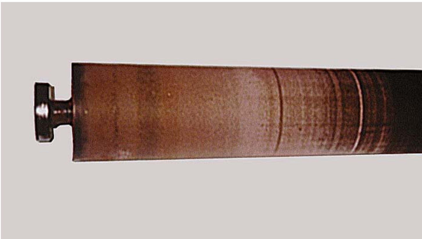
Рис. 17: Поверхность красочного валика со следами кальцевых отложений.
