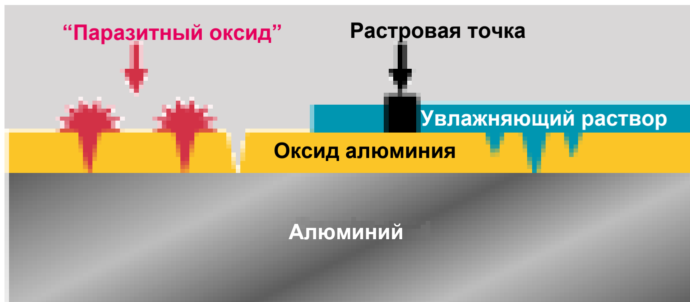
Рис. 12: Процесс коррозии печатной пластины.
