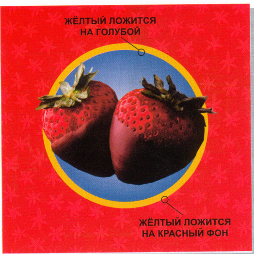
11.1.1 Треппинг изображения Треппинг изображения достигается с помощью заглушения и растяжения (chokes and spreads). Эта техника должна использоваться, когда два цвета прилегают друг к другу, будь эта графика штриховая либо растровая.
