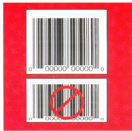
П.4.5.2 Усечение штрих-кода Некоторые виды штрих-кодов имеют фиксированное отношение между высотой и шириной, в то время как для некоторых установлена минимальная высота. Усечение штрих-кода – это уменьшение его высоты ниже установленных спецификациями стандартов, что является недопустимым.
