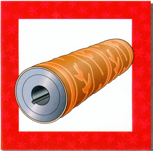
16.4 Печатные формы из резины и гильзы с лазерной гравировкой Процесс цифровой лазерной гравировки резины может также быть применён для изготовления бесшовных печатных валов (гильз) для флексографии.
