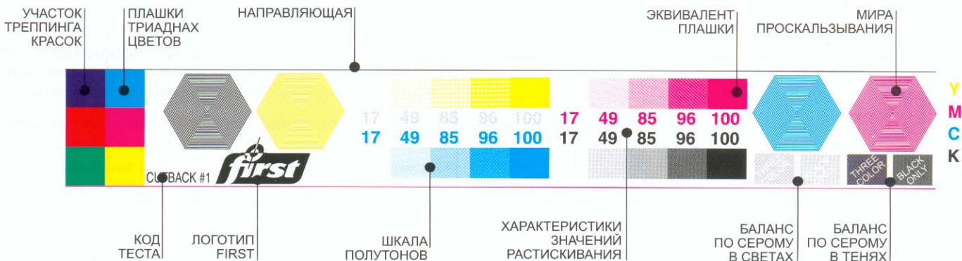
18.6 Шкалы оперативного контроля Иллюстрация внизу показывает шкалу оперативного контроля, которая включает все необходимые элементы для измерения, требуемые данными спецификациями. Доступна в ФТА.
