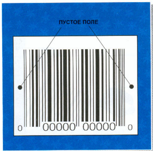
4.4.7 Чистые зоны Чистая зона - это область, свободная от печати, находящаяся с левой и правой стороны штрих-кода. Чистые зоны позволяют сканеру определить, где начинается и где заканчивается код. Размер чистых зон вычисляется из расчёта ширины наиболее узкого элемента штрих-кода (X-размер). Минимальный размер чистой зоны зависит от типа штрих-кода.
