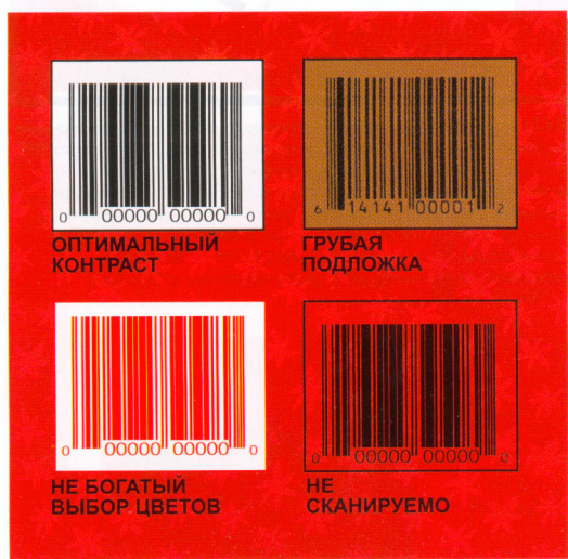
П.4.4 Цвета штрих-кода Одно из требований к штрих-коду - чёткие углы, для того чтобы сканер мог его прочесть. Штрихи и фон штрих-кода должны печататься одноцветно на одной печатной секции, поскольку точность сканирования падает, если штрихи печатаются на двух разных секциях, могут проявиться дефекты приво́дки.
