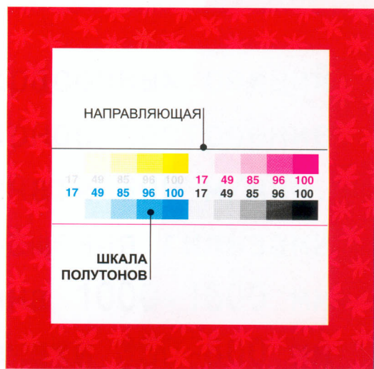
16.9.5 Контрольная полоска Линиатура растра контрольной полоски должна соответствовать линиатуре растра изображения. Использование контрольной полоски помогает проконтролировать, было ли проведённое экспонирование корректным.
