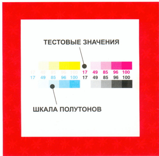
14.13.1 Фактический размер точки. Добавьте на негатив контрольную шкалу (control strip) для проверки размеров точки. Контрольная шкала является серой шкалой с 3% (или минимальным значением печати), 10%, 30%, 70% и 100%.
