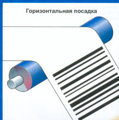
4.4.5 Штрих-коды Направление штрих-кода имеет огромное значение. Верхний рисунок показывает, как штрихи штрих-кода стандарта UPC движутся в одном направлении с рулоном, в то время как на нижнем рисунке штрихи печатаются поперечно. Если происходит смазывание при печати, в первом случае штрихи увеличиваются только в длину и всё равно их можно распознать; во втором же случае штрихи увеличиваются в ширину, что приводит к несоблюдению минимальных стандартов печати штрих-кода.
