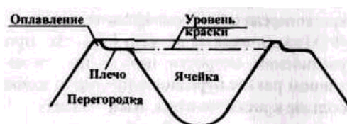
Рис. 1.66. Схема ячейки растра, полученного лазером.
