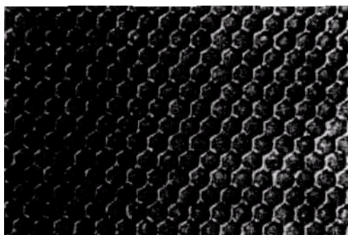
Рис. 1.64. Сотовый растр W 100/12 (разрешение — 200 лин/см, глубина — 12 мкм), полученный лазерным способом на керамике.
