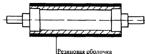
Рис. 1.26. Обрезиненный дукторный валик.
