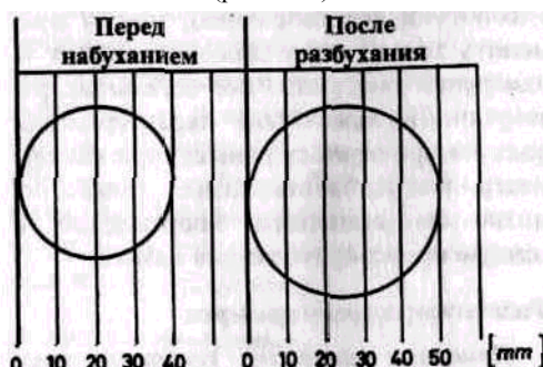
Рис. 1.67. Схематическое изображение разбухшего резинового образца (справа) и образца до разбухания (слева).
