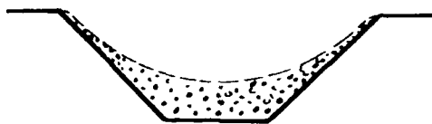
Рис. 1.60. Схема ячейки с остатками краски
