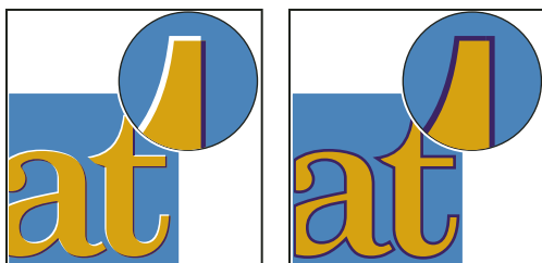
Неприводка без треппинга (слева) и с треппингом (справа)
