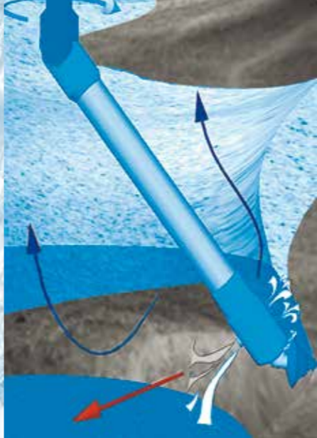
4_Схема работы гидравлического кольцевого монитора
