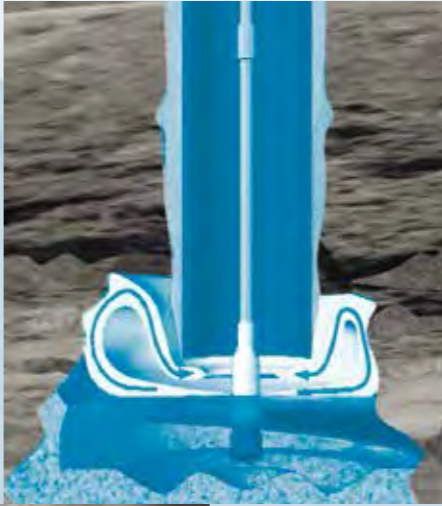
4_Схема работы гидравлического кольцевого монитора
