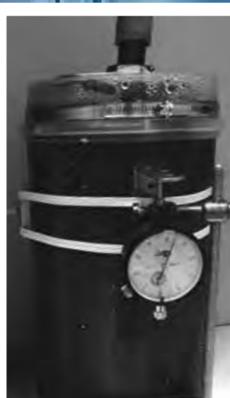
Индикатор и термометр на торце трубы со стороны входного патрубка для горячих воды или воздуха
