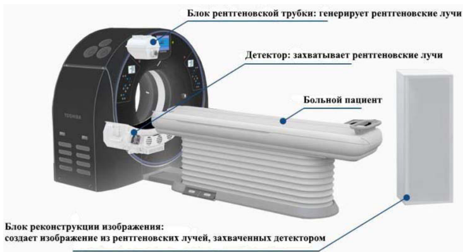
Рис. 1.14. Схематическое изображение устройства количественной КТ
