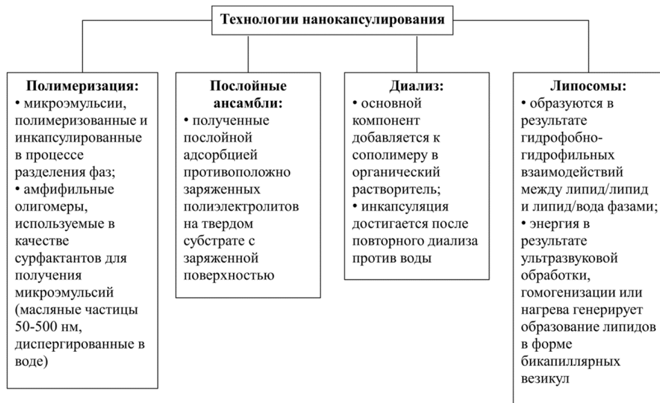
Схема 3.1. Классификация методов нанокапсулирования
