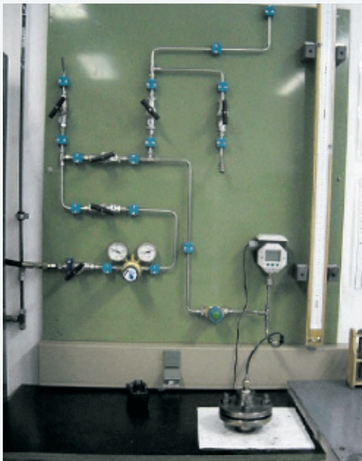
Рис. 11. Установка для определения газопроницаемости
