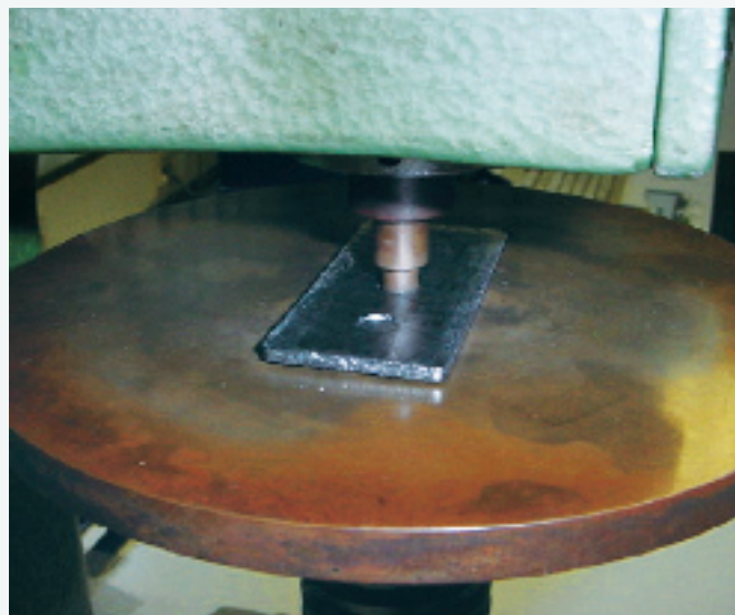
Рис. 1. Прибор, измеряющий сжимаемость и восстанавливаемость
