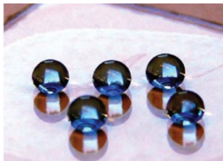
Рис. 6.12. (а) Схема получения фторсодержащих НЧ силикагеля, (б) микрофотография капель воды на поверхности супергидрофобной полиэстерной ткани
