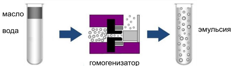
Рис. 3.3. Схема гомогенизации продуктов
