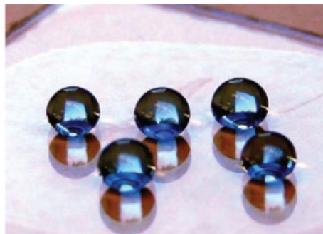
Рис. 6.12. (а) Схема получения фторсодержащих НЧ силикагеля, (б) микрофотография капель воды на поверхности супергидрофобной полиэстеровой ткани
