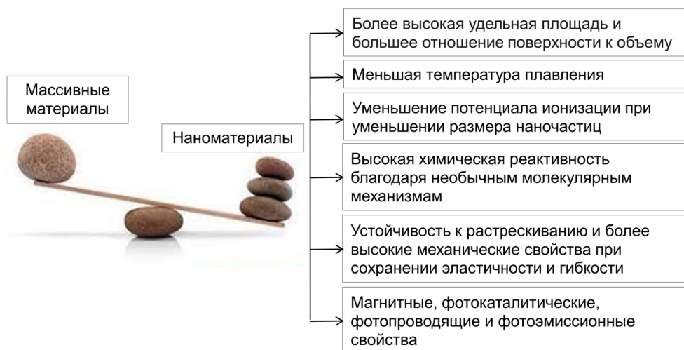
Рис. 1. Преимущества наноматериалов по сравнению с массивными материалами
