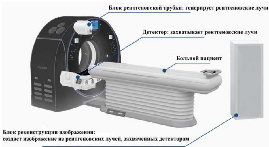
Рис. 1.14. Схематическое изображение устройства количественной КТ
